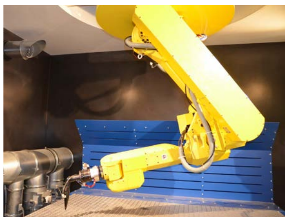
Rys. 1. Gotowa prototypowa konstrukcja podwieszonego robota spawalniczego zintegrowanego z laserem CO 2 na drugiej osi
